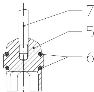
Рис. 5: Конус с упругим уплотнением
