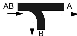
При использовании в качестве проходного серклапана вход B закрывается глухим фланцем (смотрите пункт 7.3).
