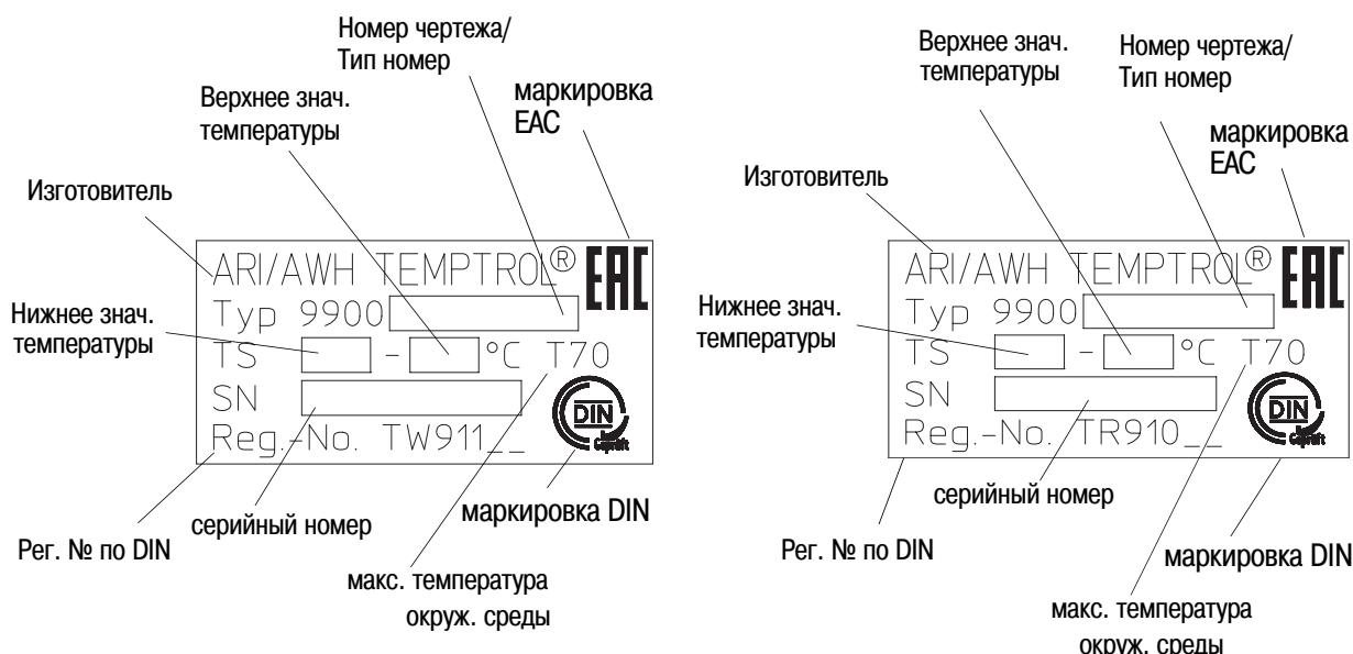
Рис. 3: Терморегулятор
